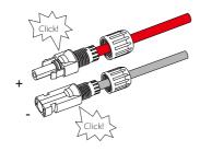
g) Tighten the cable nuts.
